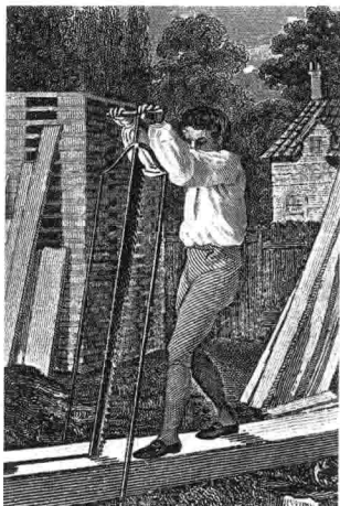
图 3.14 手工锯木工。就和所有木料一样，薄木贴面最初也是由两个锯木工切割的，一个在上一个在下。蒸汽机驱动圆锯的采用使这项工艺变得多余。摘自 Book of English Trades , R. Philips, 1823。
