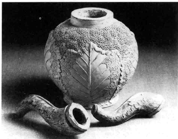
图2.10 花椰菜壶的模, c.1760 年。制模非常昂 贵,罐子的品种受到模 具种类的限制。
