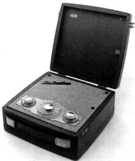
图 8.31 Ever Ready Sky Countess 便携式晶体管收音机，1959 年。电池晶体管的出现使得机箱需要有新的形象：许多制造商选择模仿轻型手提箱。
