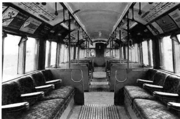
图 10.8 贝克卢线车厢，1938 年。新的车厢设计减少了木头制品的使用，让数量众多的手把和车厢内部统一起来，完善了车厢照明。
