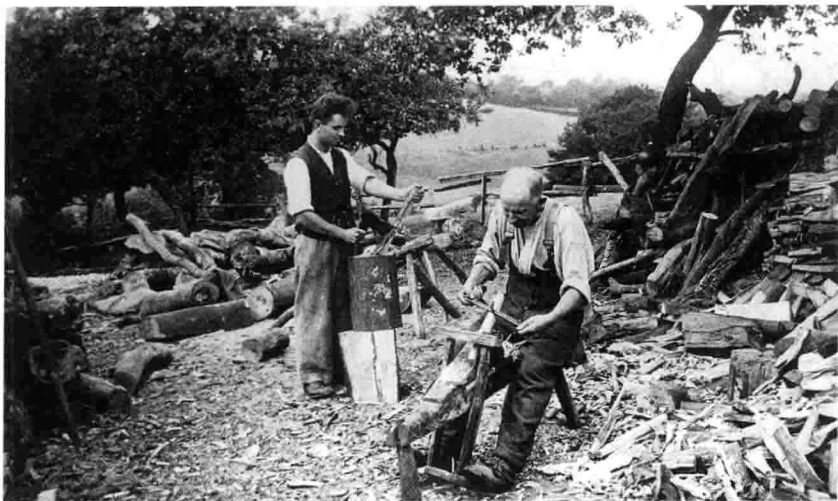
图 4.30 海威科姆附近，制作椅子的粗工手工打造椅腿，c.1920 年。机械化之前，椅子的部件是由工人在户外用最简单的工具制成的。
