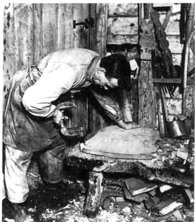
图 4.32 在海威科姆，组装椅子的工匠在面板上钻孔。这项工作的技巧在于正确判断角度。
