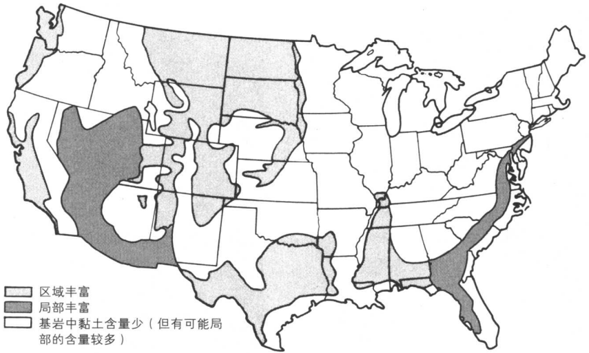
图 5.7 美国黏土（易于膨胀和收缩）分布图。黏土（蒙脱黏土）是造成挤压、地基和管道设施破坏的主要原因
