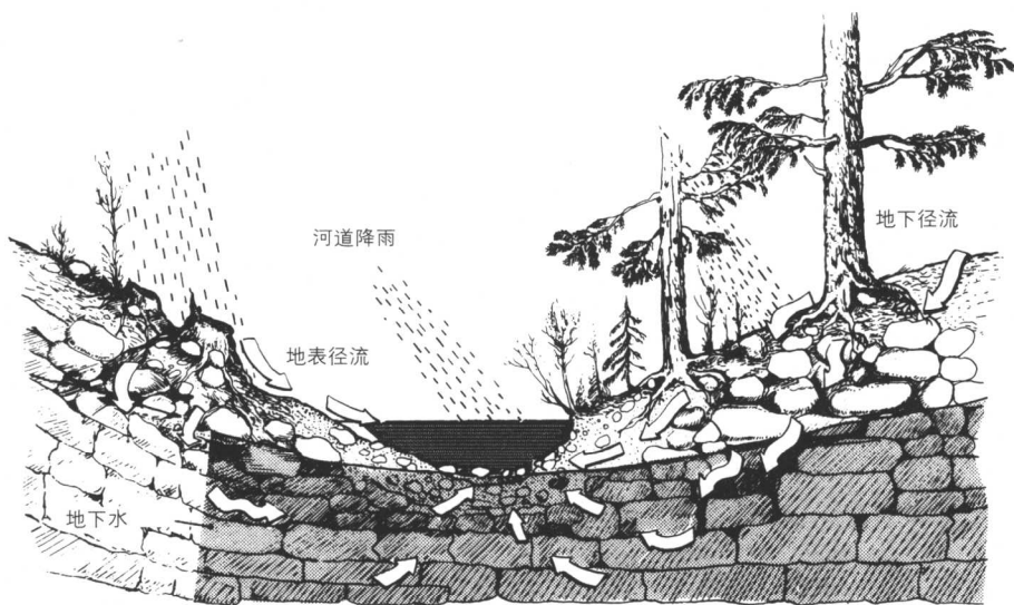
图 10.1 河川径流的来源: 河道降雨、地表径流、地下径流和地下水(根据它们进入河道的先后次序排列)
