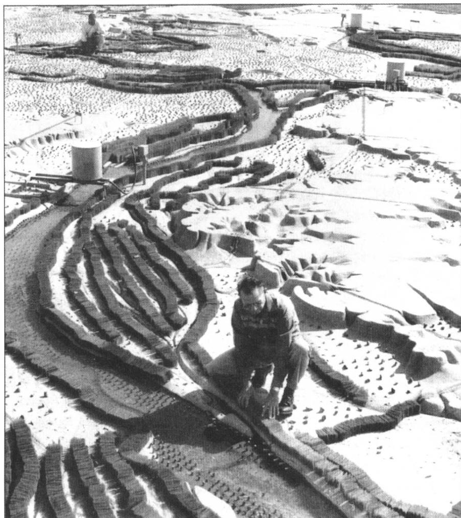
图 1.8 美国军事工程署（U.S. Army Corps of Engineers）的工程师们正在模拟密西西比河部分河段的水流行为，特别是带有森林的河漫滩。那些成排的卡片代表河漫滩上的树木
