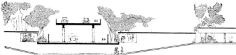
12m 宽的小汽车道。 16m 宽的重型车道。 总共 28m 宽的道路，没有行人可以进入
