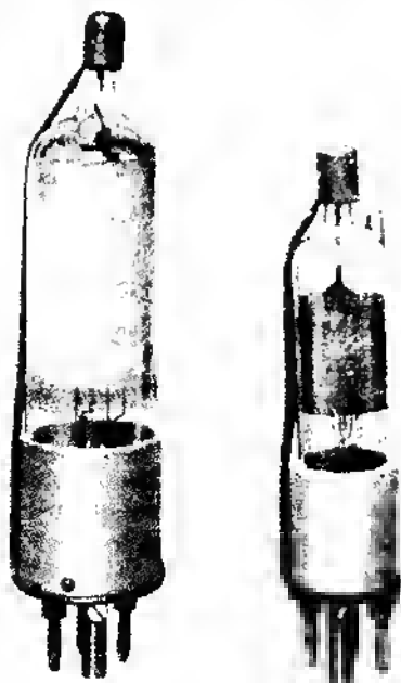
Fig. 21-44. Schott u. Gen tubes. Left: Type k. Right: Type m. (Reproduced from E. Nesper, Handbuch der drahtlosen Telegraphie und Telephonie , Vol. II, Berlin, 1921.)
